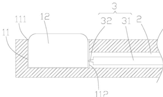
1. 一种用于微流控芯片的液体储存结构, 其特征在于, 所述存储结构包括空腔, 所述空腔的顶部设置有第一开口, 侧面设置有第二开口;
