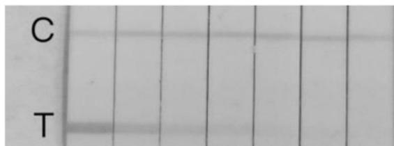
1. 一种用于发情母犬孕酮检测的试纸,其特征在于包括样本垫,结合垫,检测线T,质控线C,硝酸纤维素膜,吸水纸和PVC背衬,其中硝酸纤维素膜黏附在PVC背衬上,所述硝酸纤维素膜的一端黏附有样本垫和结合垫,另一端黏附有吸水纸,检测线T和质控线C位于所述硝酸纤维素膜的表面上,所述样本垫、结合垫、检测线T、质控线C、吸水纸五者在硝酸纤维素膜上的分布位置依次为样本垫、结合垫、检测线T、质控线C、吸水纸,所述检测线T与质控线C的间距为0.7cm;
