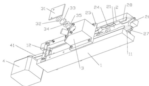
1. 一种荧光免疫分析仪,其特征在于:包括机架(1)和可在机架(1)上移动的移动试纸条架(2),移动试纸条架(2)上设有试纸条槽(21),试纸条槽(21)内设有定位装置,机架(1)上设有用于检测试纸条的检测暗室(3),移动试纸条架(2)底部连接有动力装置。
