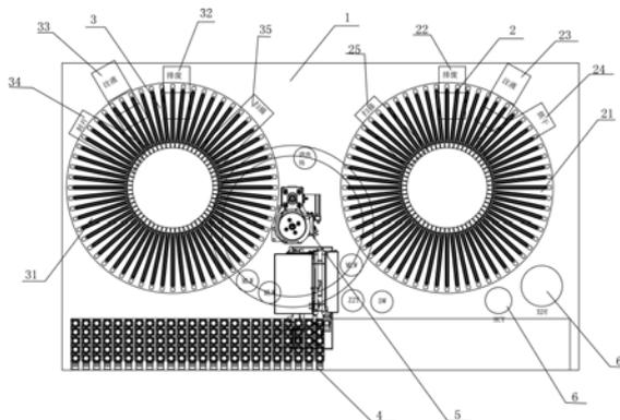
1. 一种蛋白质印迹法和免疫荧光法同盘检测装置,其特征在于,所述的同盘检测装置包括有底座、设于所述底座上的采用蛋白质印迹法进行检测的第一检测装置、用于采用免疫荧光法进行第二检测装置、用于为所述的第一检测装置和第二检测装置进行提供待检样品的自动进样装置、和所述的第一检测装置和第二检测装置配合使用以对待检样品进行加样处理的加样处理装置以及用于装载试剂瓶的试剂瓶区;所述的第一检测装置包括有第一孵育盘以及设于第一孵育盘侧边的第一排废装置、用于放置待处理样品的第一注液装置、对印迹膜条进行烘干处理的第一烘干装置和对图像信号进行采集第一扫描装置;所述的第二检测装置包括有第二孵育盘以及设于第二孵育盘侧边的第二排废装置、用于放置待处理样品的第二注液装置、进行荧光片封片的第二封片装置和对荧光片进行信号采集的第二扫描装置。
