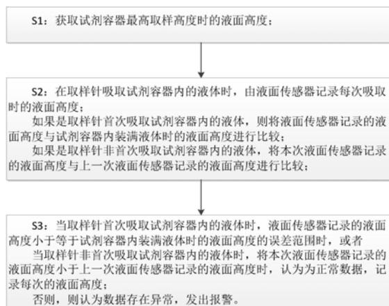
1. 一种用于化学发光免疫分析仪的试剂液面高度检测方法,其特征在于,包括以下步骤:
