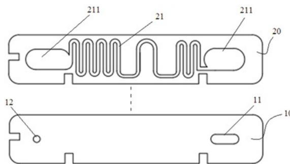
1. 一种用于干式免疫分析仪校准的校准片,其特征在于,该校准片由上盖板和下盖板盖合构成,该上盖板上设置有进样窗和出气孔,该下盖板设置有沟道,该沟道至少一端具有容纳腔,其中,下盖板的沟道的一个容纳腔与上盖板的进样窗在组合安装时位置上下对应。
