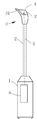
1. 骨赘切除装置,包括骨刀,所述骨刀包括连接在一起的手柄、刀杆和刀头,所述刀头具有导引翼和刀刃,其特征在于:所述刀头上固定安装有位移传感器,所述位移传感器设置于所述导引翼与刀刃之间,所述刀杆上具有轴向通孔,所述位移传感器通过传输线连接数显仪,所述传输线贯穿所述轴向通孔。
