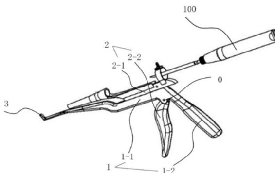
1. 一种用于超声刀的保护装置,其特征在于,包括:夹持装置和安装在夹持装置上的保护头(3);
