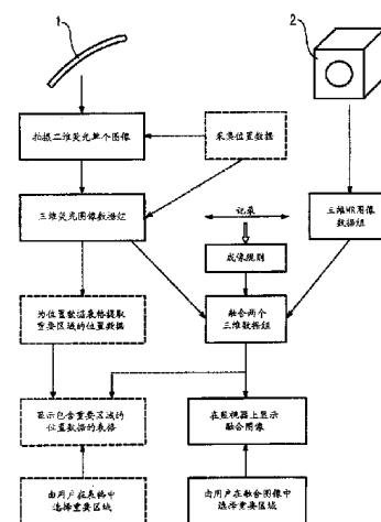
1. 一种用于融合显示由第一图像拍摄装置采集的第一图像信息和由第二图像拍摄装置采集的第二图像信息的方法，这些图像信息涉及人体或动物体的
