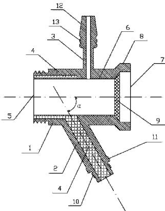
1. 一种环形导光装置,其特征在于包括环形壳体(1)及设于环形壳体(1)的侧壁上的通光管(2)和通气管(3),通气管(3)和环形壳体(1)的内腔连通,通光管(2)的内壁设有一层导光纤维层(4),导光纤维层(4)布满整个通光管(2)的内壁,所述的环形壳体(1)的内壁上设有一圈导光纤维层(4),环形壳体(1)内壁上的导光纤维层(4)位于所述的通光管(2)与环形壳体(1)的连接处和环形壳体(1)的照射端(5)之间,通光管(2)中的导光纤维层(4)和环形壳体(1)中的导光纤维层(4)相连,构成光路通道。
