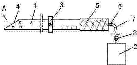
1. 一种囊肿穿刺装置,设有穿刺针和负压器,穿刺针上设有计量刻度和定位滑块,其特征在于穿刺针前端设有倾斜状弧形针尖,针尖处设有注射分流板,注射分流板和穿刺针前端部分别设有出液孔,穿刺针的后端设有操作手柄,操作手柄上设有与穿刺针相连通的连接头,导液管一端与连接头相连接,另一端与负压器相连接,导液管上设有控制阀。
