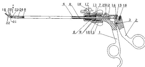
1. 一种直视翘头剪,包括固定手柄、活动手柄、钳杆、钳夹座、拉杆部件和转轮部件,其特征在于:所述拉杆部件中的拉杆设置在钳杆内,钳夹座焊接固定在钳杆上,钳夹座上焊接设置有固定剪刀,固定剪刀与水平面夹角为45°,活动剪刀通过钳连接销转动设置在钳夹座上,固定剪刀和活动剪刀相对咬合面设有刀刃,活动剪刀的底端通过拉杆连接销设置在拉杆连接头的一端,拉杆连接头的另一端与拉杆一端焊接固定,拉杆的另一端设置有拉杆座,拉杆座套入活动手柄上的拉杆槽固定。
