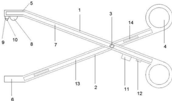
1. 一种妇产科电子检查宫颈钳,包括支撑钳柄(1)和操作钳柄(2),其特征在于:所述支撑钳柄(1)和操作钳柄(2)交叉设置,且支撑钳柄(1)和操作钳柄(2)的交叉处设有活动钳轴(3),所述支撑钳柄(1)和操作钳柄(2)的右端均焊接有操作环(4),所述支撑钳柄(1)的左端焊接有支撑块(5),所述操作钳柄(2)的左端焊接有操作块(6),所述支撑钳柄(1)和支撑块(5)的表面之间焊接有走线盒(7),所述支撑块(5)的底部中央通过灯座设有照明灯(8),所述支撑块(5)的底部左侧设有连接块(9),所述连接块(9)的底部嵌有内窥镜(10),所述支撑钳柄(1)的底部右侧螺接有电池盒(11),所述电池盒(11)的右侧设有开关(12),所述开关(12)与支撑钳柄(1)的底部右侧螺接,所述操作钳柄(2)的表面焊接有滑槽(13),所述滑槽(13)的内腔设有清理装置(14)。
