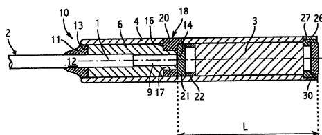
1. 一种用于装配柔性光纤束(2)远端的微型光头，所述微型光头包含用于将来自所述光纤束的激励信号聚焦到所谓的激励焦点的光学装置(3, 21)，该激励焦点位于分析表面之下的给定深度处，该光学装置(3)还用于采样被激励焦点反向散射、并被所述光纤束传输回去的信号，其特征在于，光学元件保持管(4)，其剖面为圆形，其中在其一侧上插入光纤束(2)的远端部分(1)，而在另一端插入光学装置，后者包括与光纤束的末端(14)相接触放置的盘(21)，其折射率接近于纤芯的折射率，以及聚焦光学块(3)，输出窗口(30)也与分析表面相接触，适用于提供折射率调整从而消除分析表面上出现的杂光发射。
