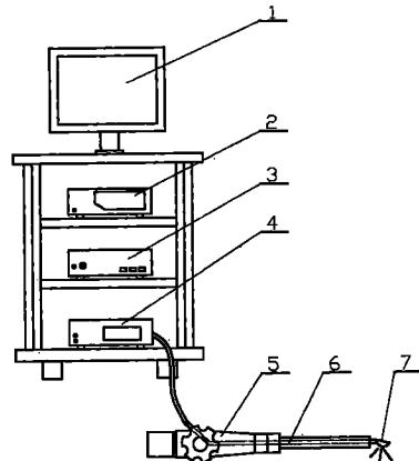
1. 一种微创诊断图像分析仪,包括显示器(1)、冷光源(2)、计算机(3)、图像处理器(4)、内窥镜主体(5)、传像光纤(6)和超清扫扫描诊断探头(7);该分析仪有一个方便握持的内窥镜主体(5),该内窥镜主体(5)的前端设有照明灯与冷光源(2)电连接;其特征是:该内窥镜主体(5)的钳道孔内插入一条加长的传像光纤(6);该传像光纤(6)的一端与图像处理器(4)插接,另一端延伸至钳道孔的前端伸出,并连接有可自行旋转360度的超清扫扫描诊断探头(7)。
