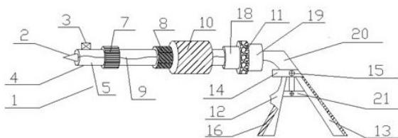
1. 一种腹腔镜用超声波探头，它包括本体，所述本体包括电动伸缩杆、第一手柄、第二手柄和驱动电机，其特征在于：所述电动伸缩杆左端设置有探头；所述电动伸缩杆上方设置有LED灯；所述电动伸缩杆内部设置有内腔；所述电动伸缩杆表面设置有超声波发出装置；且所述超声波发出装置右侧设置有超声波接收装置；所述超声波接收装置右侧设置有信息处理装置；所述信息处理装置右侧的电动伸缩杆表面设置有驱动电机；所述驱动电机右侧设置有电源；且所述电动伸缩杆另一端连接有套筒；且所述套筒另一端和连接件相连接；所述连接件底部通过固定件分别和第一手柄以及第二手柄相连接；所述第一手柄和第二手柄之间设置有支撑件；所述第一手柄和第二手柄表面设置一层防滑套；且所述电动伸缩杆表面覆盖一层橡胶层。
