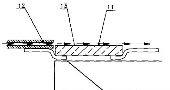
1. 一种平面型视窗内窥镜的镜面防污染装置,包括内窥镜,所述内窥镜的视窗镜面为平面,其特征在于:所述内窥镜的视窗镜面侧边设有喷嘴;所述喷嘴连接高压气源,其射流方向平行于内窥镜的视窗镜面。
