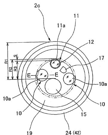
1. 一种超声波内窥镜，在其插入部的顶端硬质部上安装有将前方作为观察视野的内窥镜观察部件、以及超声波观测部件，其中，该超声波观测部件是在该顶端硬质部的外周部上沿圆周方向排列规定数目的超声波振子并具有圆周状或者圆弧状的扫描范围，其特征是：
