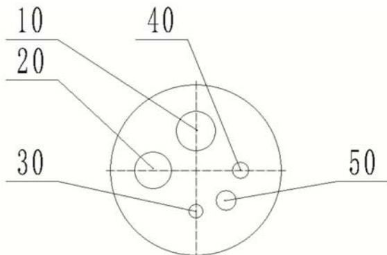
1. 一种电子内窥镜接头,其特征在于,包括相互匹配的镜体侧和冷光源侧,所述接头包括第一光信号传输通路、第二光信号传输通路和接触式供电部;
