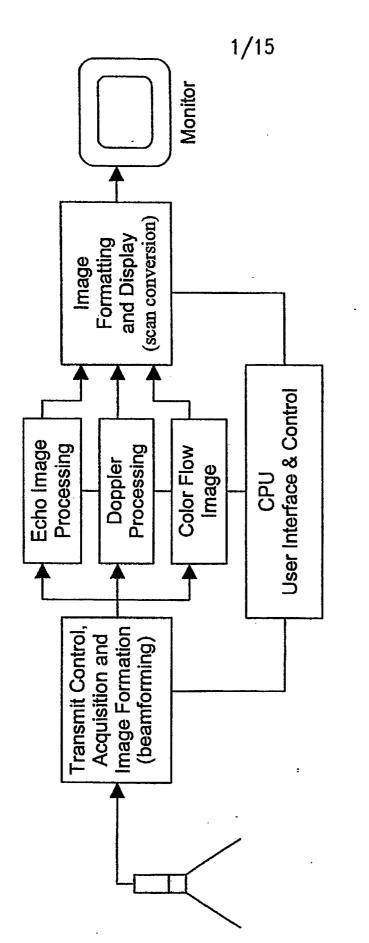
FLOW-THROUGH SYSTEM ARCHITECTURE USED BY CURRENT ULTRASOUND SYSTEMS.
