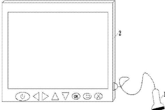
1. 一种便携智能超声骨密度测量分析检测系统,其特征在于,所述的一种便携智能超声骨密度测量分析检测系统;包括人体检测传感器、微电脑控制处理设备、强大的后台数据库、远程传输装置。
