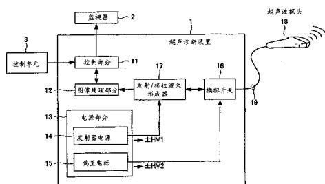
1. 一种用于从超声波传感器向待检测物体发射超声波信号并接收所述超声波信号的反射波用于显示的超声波诊断装置，包括：
