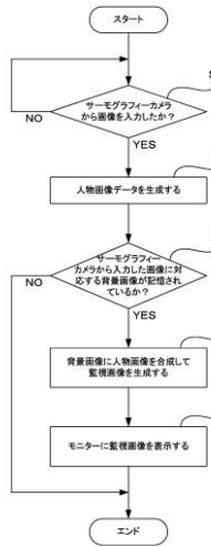
本実施形態による監視装置の動作及び監視画像表示方法を示すフローチャート
