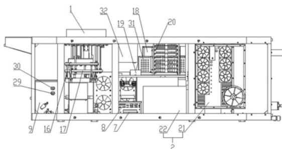
1. 一种光声乳腺成像系统,其特征在于:包括检测水槽(1)以及与检测水槽(1)相连的水循环系统和光声采集系统,所述检测水槽(1)内设置平透镜,所述光声采集系统包括激光器(2)、光纤(3)、散射片(4)和环形阵列探测器(5),
