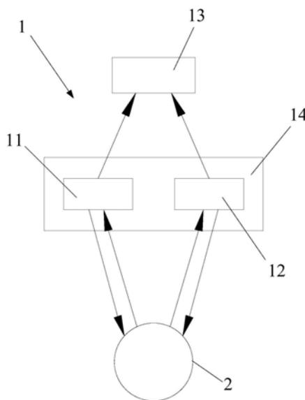
1. 一种生物体征检测装置,其特征在于:包括雷达检测机构、视频检测机构和处理机构,所述雷达检测机构和所述视频检测机构分别与所述处理机构电连接;所述雷达检测机构用于向预设的方向发射电磁波,并接受反射后的回波信号,将接收的回波信号传递给处理机构,所述处理机构对接收的回波信号进行处理得到初步的人体体征信息;所述视频检测机构用于采集人体检测时的视频信号,并将采集到的视频信号传递给处理机构,所述处理机构根据检测到的视频信号对初步的人体体征信息进行矫正得到最终的人体体征信息。
