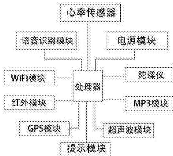
1. 一种盲人服务装置,其特征在于:包括壳体(1)和处理器(2),所述处理器(2)设置在壳体(1)内,所述壳体(1)内设有分别与处理器(2)连接的语音识别模块(3)、WiFi模块(4)、红外模块(5)、GPS模块(6)、超声波模块、陀螺仪和MP3模块(7)。
