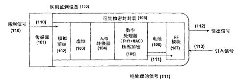
1. 一种监测设备，包括信号接收机、虚地、数字处理器和收发机，所述信号接收机具有接收包含病人生命体征的感测信号的能力，所述虚地包括在监测设备内部、或者在没有物理附连的两个或以上传感器之间或在两个或以上监测设备之间导致毫微伏脉冲生成的电路，并使用所述毫微脉冲生成用来与所述感测信号相比较的基线信号，所述收发机具有将已处理的信号从所述数字处理器无线地发送至基站或无线网关并从所述基站或所述无线网关接收引入信号的能力，并且所述数字处理器具有在所述监测设备内本地处理所述感测信号和所述引入信号的能力。
