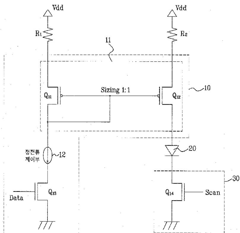
专利名称(译) 用于平板显示装置的电流控制装置
