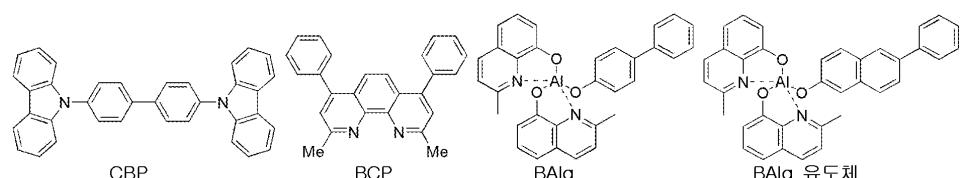
[0012] 그러나 기존의 재료들은 발광 특성 측면에서는 유리한 면이 있으나, 유리전이온도가 낮고 열적 안정성이 매우 좋지 않아서, 진공 하에서 고온 증착 공정을 거칠 때, 물질이 변하는 등 단점을 갖고 있다. OLED에서 전력효율 = ( $\pi$ /전압) × 전류효율 이므로, 전력효율은 전압에 반비례하는데, OLED의 소비 전력이 낮으려면 전력 효율이 높아야한다. 실제 인광 발광 재료를 사용한 OLED는 형광 발광 재료를 사용한 OLED에 비해 전류 효율(cd/A)이 상당히 높으나, 인광 발광 재료의 호스트로 BA1q 나 CBP 등 종래의 재료를 사용할 경우, 형광재료를 사용한 OLED에 비해 구동 전압이 높아서 전력 효율(lm/w)면에서 큰 이점이 없었다.
