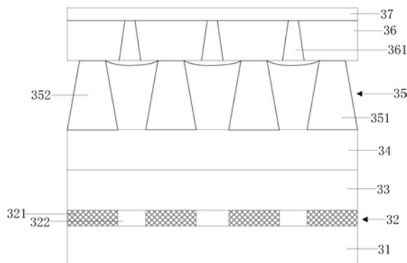
1. 一种OLED显示器件,其特征在于,包括TFT阵列基板、密封板和发光器件,所述密封板设置于所述TFT阵列基板上,与所述TFT阵列基板形成密闭空间,所述发光器件设置于所述密闭空间内的TFT阵列基板上,所述发光器件包括依次层叠的碳化硅衬底、光通过层、阴极层、感光树脂层、有机层、阳极层和透明导电超疏水薄膜,所述有机层包括呈矩阵分布在所述感光树脂层上的隔离层以及设置在所述多个隔离层之间的发光层,所述发光层的表面向下凹陷形成曲面,所述阳极层具有多个贯通的通孔,所述通孔的位置与所述发光层的位置相对应,所述光通过层包括光间隔区和光通过区,所述光间隔区呈矩阵分布所述碳化硅衬底上,所述光通过区形成于所述光间隔区之间,所述光间隔区的材料为遮光板,所述光通过区的材料为导光板,所述光通过区与所述发光层的位置相对应。
