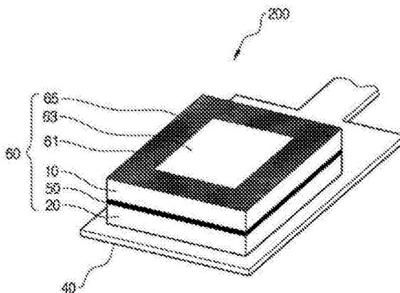
1. 一种有机发光器件面板,其特征在于:包括有机发光器件面板(60)、和有机发光器件面板(60)电性连接的柔性印刷电路板基板(40),所述有机发光器件面板(60)设置在柔性印刷电路板基板(40)上面;
