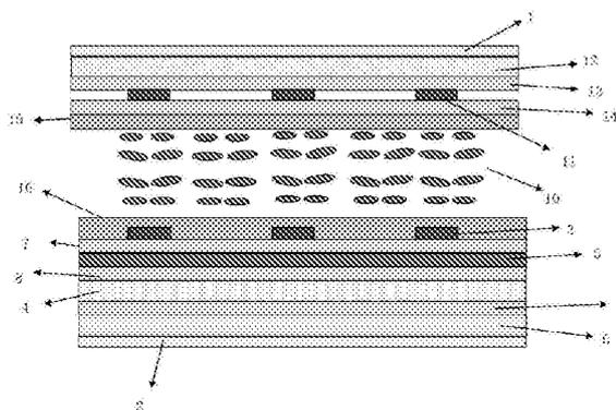
1. 一种液晶显示装置,包括上基板和下基板、设置在上基板和下基板之间的液晶分子,其特征在于:所述下基板上包括第一对电极,所述上基板包括与所述第一对电极对应的第二对电极;所述第一对电极包括第一像素电极和第一公共电极;所述第二对电极包括第二像素电极和第二公共电极;所述第一像素电极和第二公共电极之间、以及第二像素电极和第二公共电极之间均设有绝缘层;
