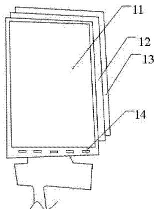
1. 一种 LCD 模组, 其特征在于, 包括依次叠置的 LCD 本体、导光片和镜面钢片, 在所述 LCD 本体的一侧设置有至少一个 LED 光源。
